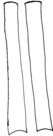
Limpiar el tubo con ethanol o en su defecto, agua y jabón. Utilizar la cinta americana para unir de nuevo las dos mitades cortadas firmemente, reforzando los bordes de los dos extremos del tubo.
