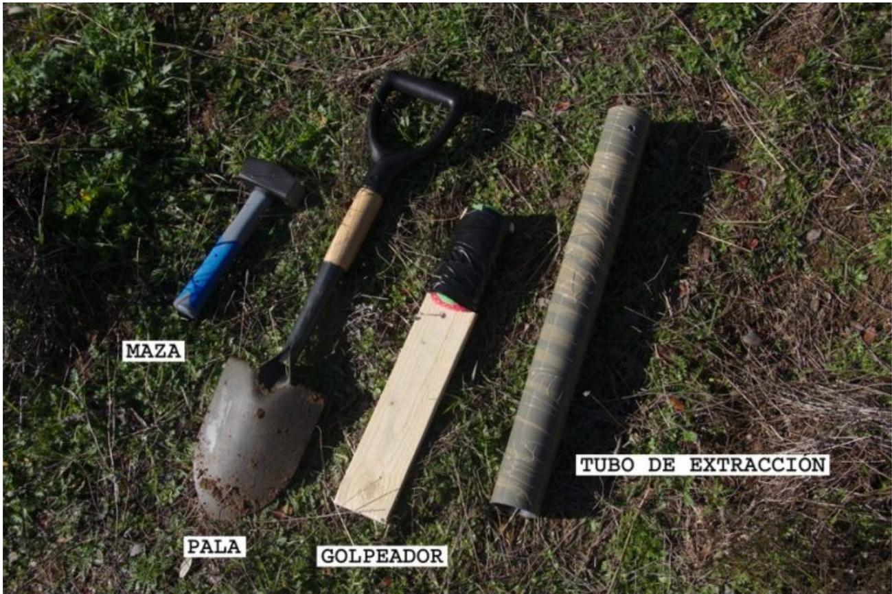
Una vez elegida la zona, limpiar la superficie y cavar cinco o diez centímetros antes de colocar el tubo para evitar raíces de superficie que puedan empujar la muestra.
